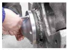
Der RadEye GR Detektor lässt sich bei den meisten verwendeten Greifertypen einfach und schnell installieren. Auf Grund seiner kompakten Bauweise hat er nur einen geringen Platzbedarf und er beeinflusst auch nicht wesentlich die Ladekapazität des Greifers. Fragen Sie uns nach Installationshinweisen!
